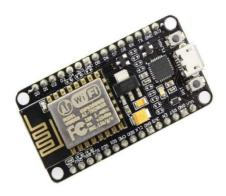
FIG 1 : NodeMCU Board
