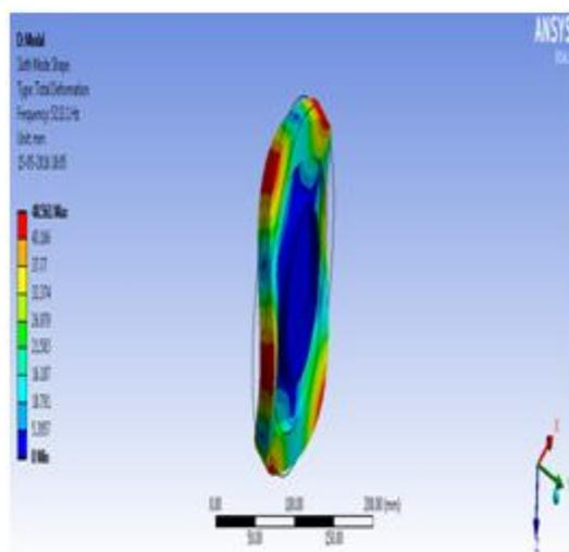
Fig. 21. Mode 5 at 5213.1Hz
