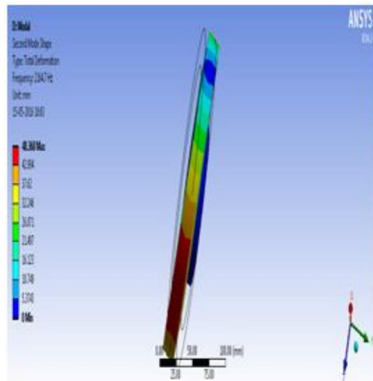
Fig. 17. Mode 2 at 2164.7Hz
