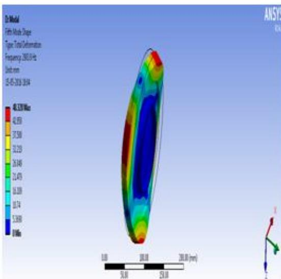
Fig. 20. Mode 5 at 2903.7Hz
